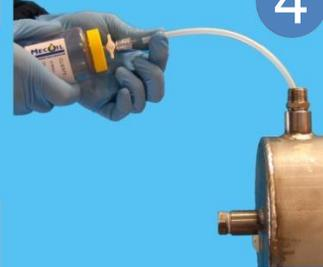
Collegare l'altro estremo del tubo per il prelievo alla valvola montata sul tappo del flacone UCVD.
