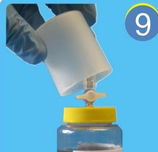
Riposizionare il tappo di sicurezza sul flacone UCVD ed inviare il campione al laboratorio di analisi Mecoil.
