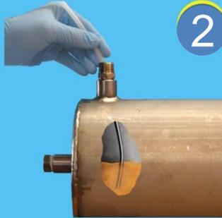
Inserire il tubo monouso nel punto di campionamento finché un estremo non è immerso completamente nell'olio. \*
