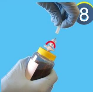
Chiudere il flacone UCVD ruotando nuovamente di 90° la valvola e scollegare il tubo di prelievo.
