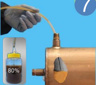
Raggiunto l'80% del volume del flacone, estrarre l'estremo del tubo inserito nell'olio. Il vuoto residuo pulirà anche il tubo evitando possibili sversamenti.
