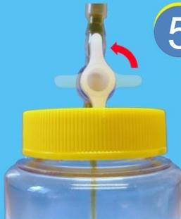
Collegato il tubo, basta ruotare di 90° la valvola per permettere al vuoto di aspirare in automatico l'olio nel flacone.
